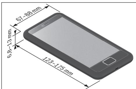
De aangegeven afmetingen zijn inclusief hoesje. Smartphones met **klap- en etuihoesjes** mogen niet worden bevestigd. Het totale gewicht mag niet hoger zijn dan 276 g.
