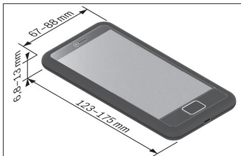
Las dimensiones indicadas se entienden con envoltura. No se deben colocar teléfonos inteligentes con **fundas y cubiertas**.
